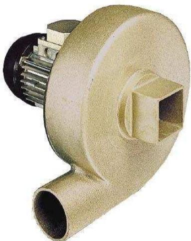
**Aspiratore centrifugo con motore elettrico Mec 63, costruzione B3-B14 o B14. Ventola in alluminio mm. 200x47. Chiocciola in alluminio fuso sabbiata. Bocca di mandata tonda. Bocca d'aspirazione con versione quadra, tonda o piatta. Attacco di fissaggio mediante i piedi del motore, o a flangia con 6 perni posizionati sulla chiocciola. IMPIEGHI: impianti di lavanderia, smacchiatrici, macchine lavametalli, per lavori con solventi, impianti di fumi.**
